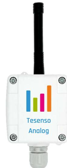
Die Schnittstelle 4..20mA zu LoRa ermöglicht die Übertragung jedes analogen Signals, das dem Standard der Stromschleife 4..20 mA entspricht. Dieser Konverter ermöglicht den Anschluss eines beliebigen Sensors oder Aktors über ein Paar elektrischer Leiter, in denen ein Strom zirkuliert, dessen Stärke proportional zum zu übertragenden Signal ist.
